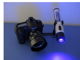
特殊波長光線による撮影システム
