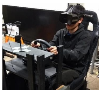
視線計測可能なHMDによるVRシミュレータ実験風景
