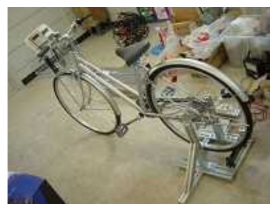
完成した自転車発電装置
